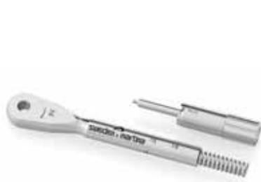
Desatornillar totalmente el tornillo de regulación del torque y sacar el resorte contenido dentro del mango del cuerpo de la carraca. No separar el resorte del poste que funciona como tope.
