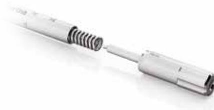
Lubricar el resorte dentro del mango de la carraca, tal y como mostrado en la figura. Ensamblar el tornillo de regulación del torque comprobando la funcionalidad correcta del instrumento y activando manualmente la rueda de trinquete.
