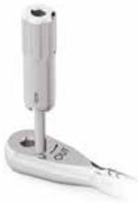
Una vez introducidas y lubricadas las partes 2 y 3 en la cabeza del cuerpo de la carraca, colocar la tapa y girar el cuerpo de la carraca desde el lado OUT. Apretar el tornillo con la punta hexagonal del tornillo de regulación del torque.
