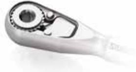
Lubricar las zonas de contacto entre el diente de la rueda de trinquete y el poste del diente de sujeción de rueda.
