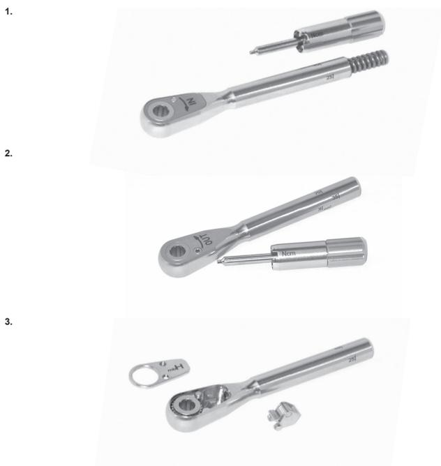
**F: Paso de montaje de la llave dinamoétrica de carraca y piezas a lubricar**
