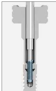
Figura 1. Freza cârlig cu ghidaj, în contact cu șurubul rupt
