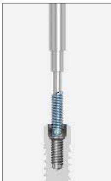
Figura 2. Șurub rupt în faza de îndepărtare, prins de freza cu
