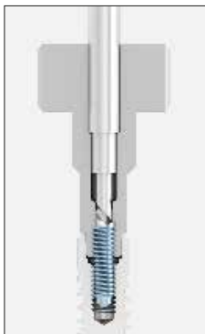
Figura 3. Freza spirală cu ghidaj, în contact cu șurubul rupt
