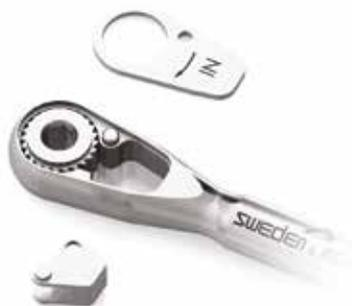
Après avoir lubrifié les parties indiquées par la figure, insérer les deux éléments qui composent la tête de la clé à cliquet dans l'ordre suivant : molette dentelée puis la dent d'arrêt de la molette.
