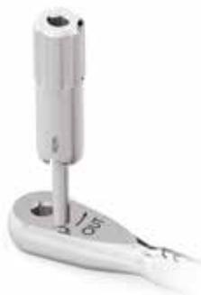
Après avoir inséré et lubrifié les parties 2 et 3 dans la tête du corps de la clé à cliquet, placer le couvercle et tourner le corps de la clé à cliquet du côté OUT. Serrer la vis avec la pointe hexagonale de la vis de réglage du couple de serrage.
