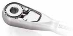
Lubrifier les zones de contact entre la dent de la molette et le pivot de la dent d'arrêt de la molette.
