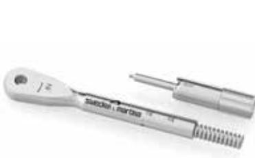
Dévisser complètement la vis de réglage du couple de serrage et extraire le ressort se trouvant à l'intérieur du manche du corps de la clé à cliquet. Ne pas séparer le ressort de l'axe qui sert de butée.
