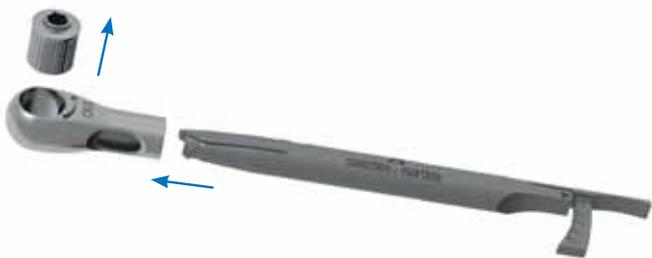
Appuyer sur le tournevis et l'extraire de la tête de la clé, puis enlever la tête en appuyant dans l'évidement, en l'extrayant avec délicatesse. Les trois parties séparées sont prêtes pour le nettoyage.
