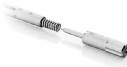
Lubrifier le ressort à l'intérieur du manche de la clé à cliquet comme illustré sur la figure. Assembler la vis de réglage du couple de serrage en vérifiant le fonctionnement correct de l'instrument et en activant manuellement la molette.
