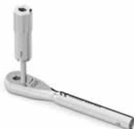
Avec la pointe hexagonale située à la base de la vis de réglage du couple de serrage, dévisser et extraire complètement la vis de serrage du couvercle sur le côté portant l'indication OUT. Exercer une légère pression pour éviter d'endommager la pointe hexagonale.
