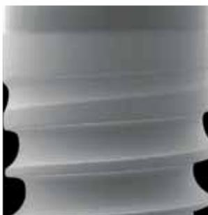
La spire de l'implant Prama présente un profil asymétrique et son filet a un pas de 1,00 mm et une profondeur de 0,40 mm.
