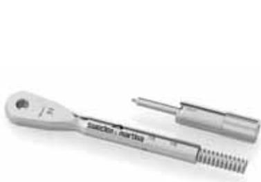
Dévisser complètement la vis de réglage du couple de serrage et extraire le ressort se trouvant à l'intérieur du manche du corps de la clé à cliquet. Ne pas séparer le ressort du goujon servant de butée.
