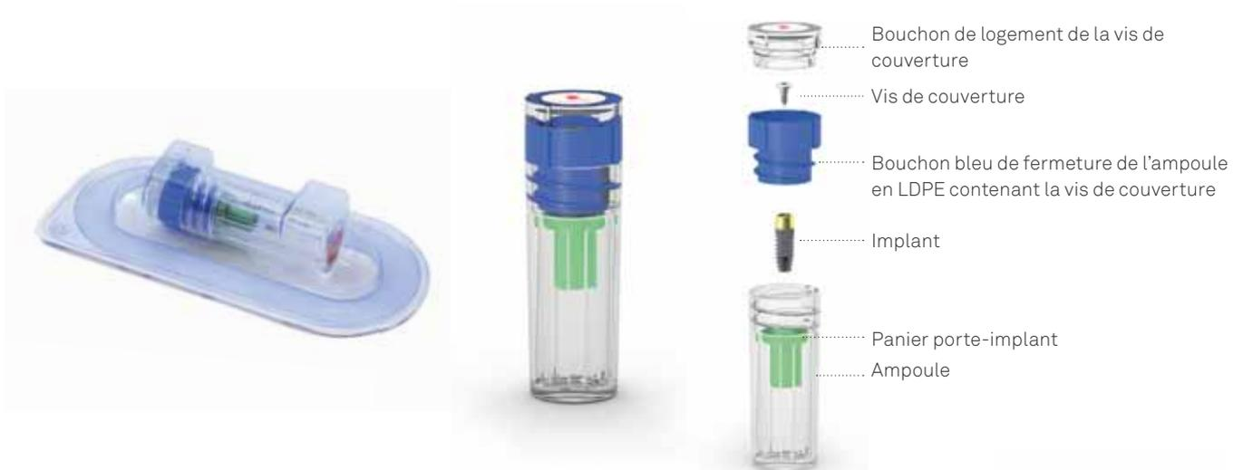
**3** Immédiatement avant l'insertion dans la cavité orale, enlever le bouchon bleu de l'ampoule en veillant à ne pas enlever le petit bouchon transparent étant placé dessus et contenant la vis de couverture. Le petit cylindre porte-implant à l'intérieur de l'ampoule est coloré selon un code couleur qui permet une identification rapide du diamètre endo-osseux de l'implant.
