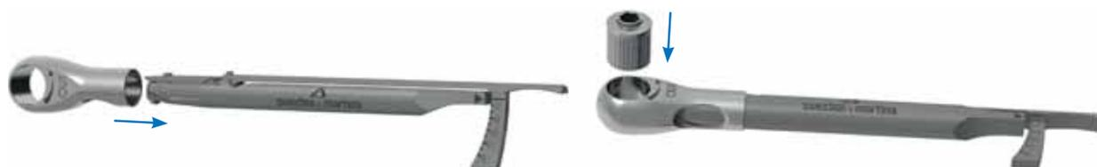
Après le nettoyage, remonter la tête de la clé sur le corps en poussant les composants ensemble et en les faisant tourner dans des directions opposées jusqu'à la perception d'un déclic.
